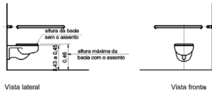
Figura 119 — Adequação de altura da bacia sanitária suspensa
