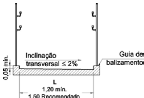
Figura 80 — Inclinação transversal e largura de rampas - Exemplo
